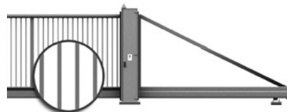
Fyllning för stängd lådsektion 30 x 18 mm, fastsvetsad på strukturen.
