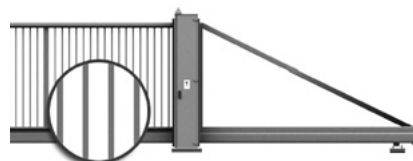
Fyllning för stängd lådsektion 25 x 25 mm [mm], CARO-arrangemang, fastsvetsad på strukturen.
